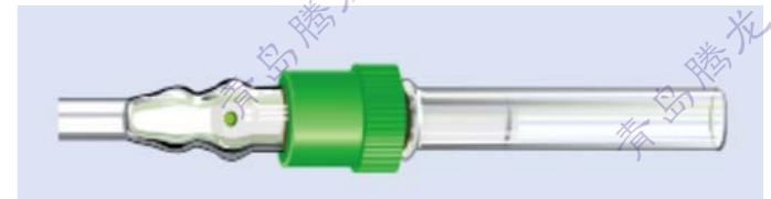
使用阀门核磁管无需对核磁管进行熔融就可以实现对样品密封。特氟龙O圈消除了材料不兼容问题。阀门配件全部使用特氟龙材料，令使用更安全，拆装清洗更加方便。具有套筒装置可以将它快速连接到真空装置上，让核磁内部形成真空，更好地保护样品。
