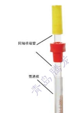
当需要测试的样品要用到参照溶剂时（外标），可选择使用同轴核磁管。通过精密的设计同轴核磁管可与5mm和10mm薄壁核磁管配套使用。
